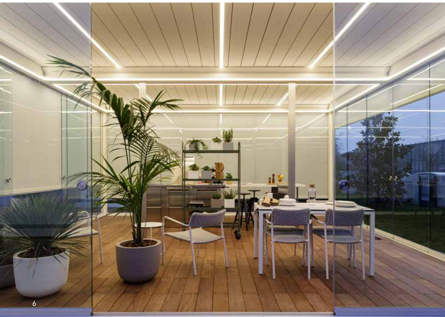
**FR** I La configuration principale d'IMAGO est autoporteuse mais il y a également la possibilité d'installer la structure adossée au mur. Les piliers de 15x15 cm de section ont été conçus pour abriter à la fois un tuyau de descente pour conduire l'écoulement de l'eau et les glissières latérales des screens - pour un encombrement maximal de 33x33 mm.
